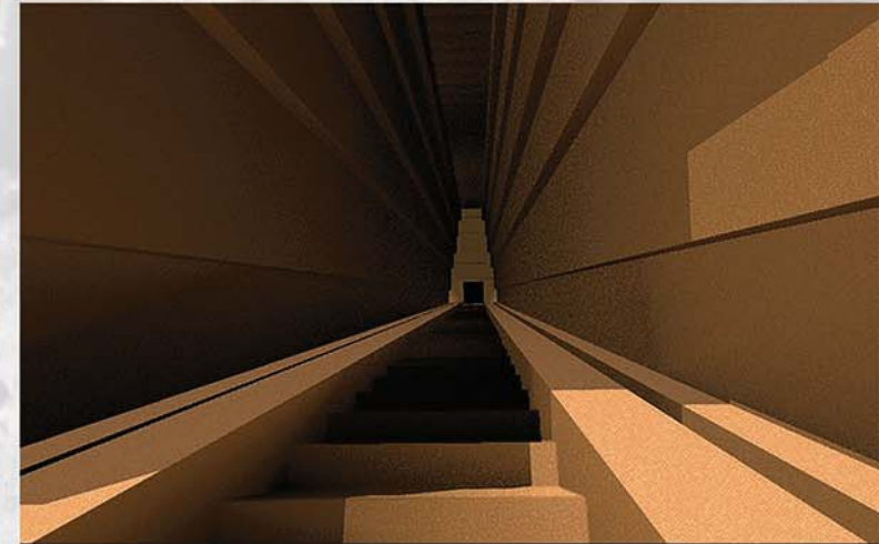
Gran Pirámide. Gran Galería construida con piezas en voladizo. Esquema conceptual
