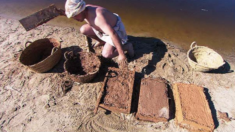
Ejecución de adobe
