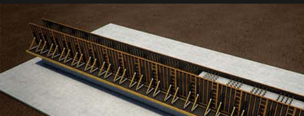
Encofrado a doble cara
